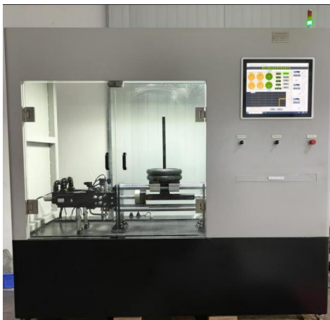
泵&马达型式试验台 Hydraulic pump & motor testbed
