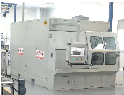
泵&马达型式试验台 Hydraulic pump & motor testbed
